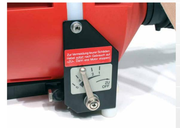
Die Regelung der Präparatzufuhr erfolgt über das Einstellen des Kugelventils. Die Partikelgröße nimmt mit steigender Präparatzufuhr zu.
