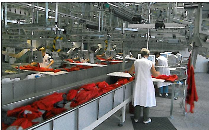
Abb.: Von der Waschmaschine auf den Bügel. Nach der umweltgerechten Wäsche wird die Kleidung auf Sauberkeit kontrolliert und für die weitere Bearbeitung vorbereitet.
