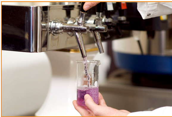
Bei einem rosaroten Ablauf ist die Schankanlage frei von Verschmutzungen.
