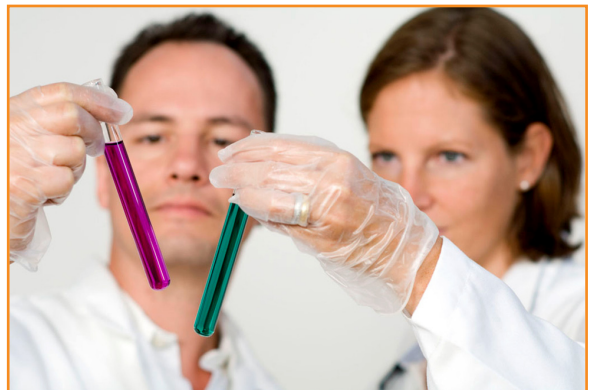
Eine grüne Farbe bedeutet, dass noch Reinigungsbedarf besteht.
